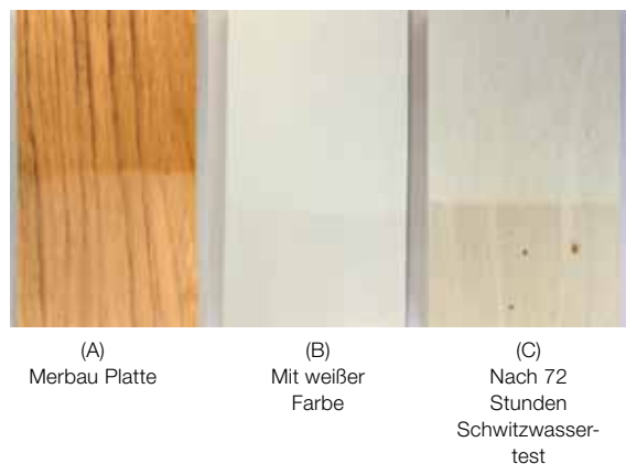
Abbildung 2: Anwendung von NECOWEL™ 4300 als Isolierimprägnierung
